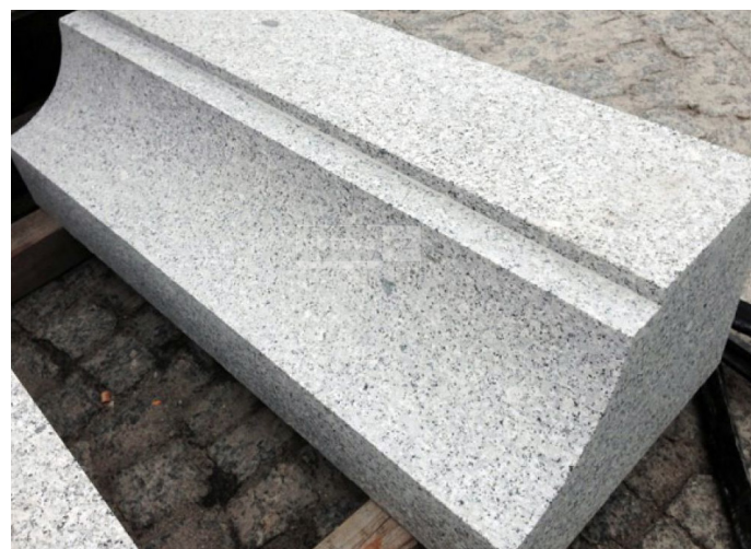
příklad řešení nástupní hrany zastávky žulový kasselský obrubník v. 16cm
