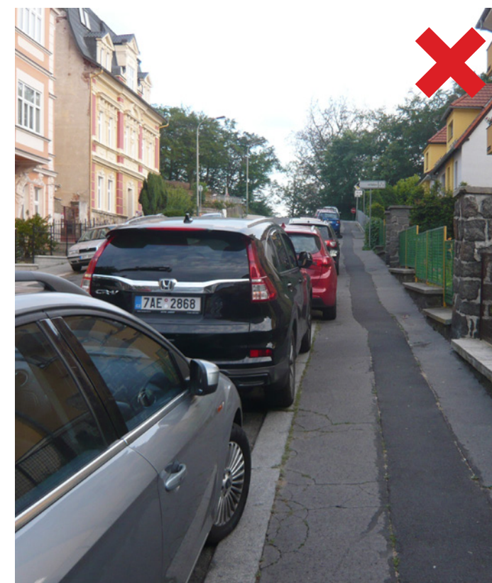
Obr. 12 Nevhodný profil ulice způsobuje parkování vozidel na chodníku a s tím spojené zmenšení prostoru pro pěší.
