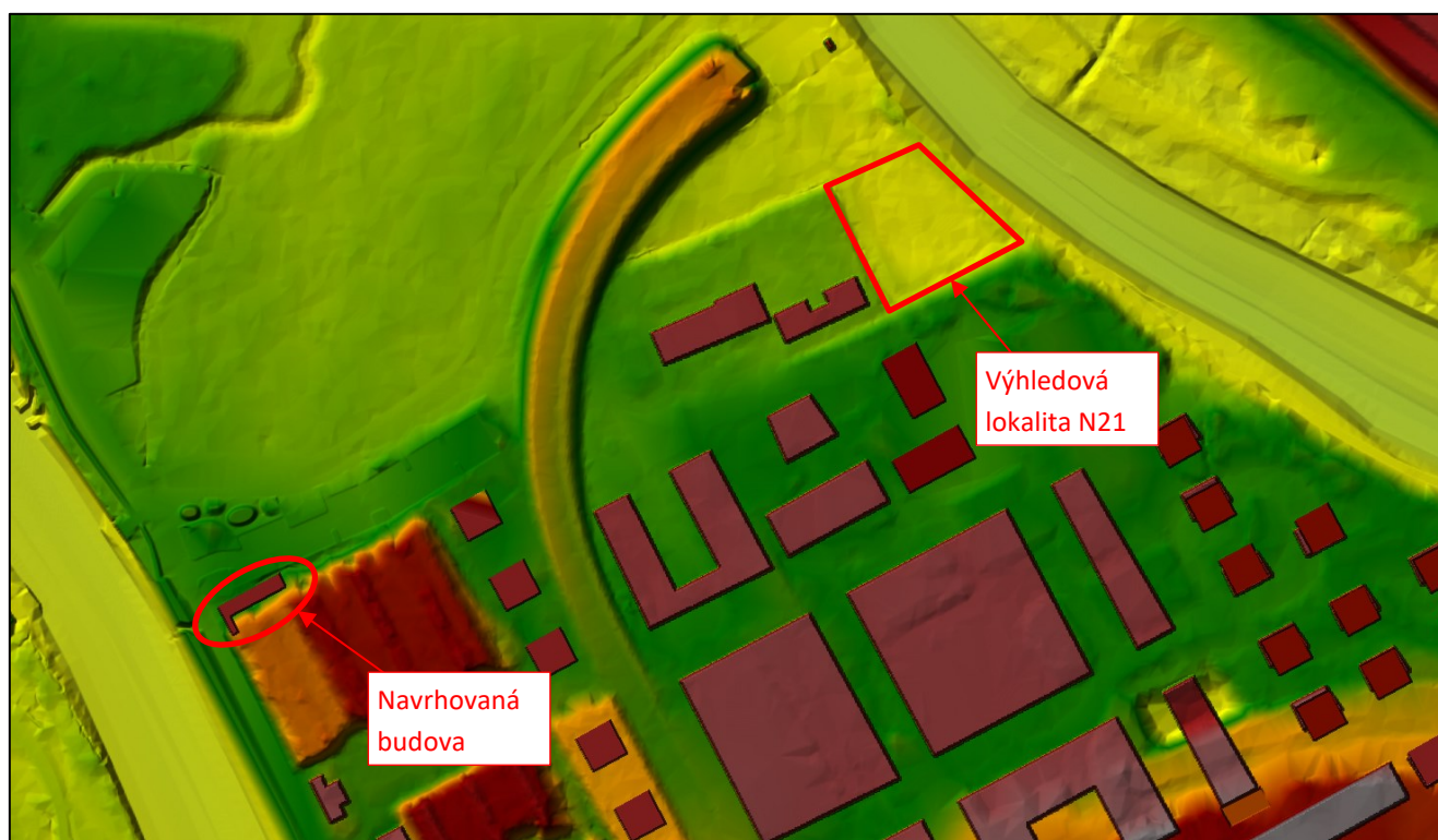
obr. 4-1: Digitální model terénu návrhového stavu se zobrazenými problematickými lokalitami
